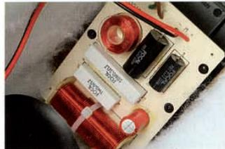
Nous pouvons voir sur les photos : le haut-parleur de grave-médium et son châssis renforcé pour l'aération de l'équipage mobile ; le tweeter inversé, protégé par un cache métallique ; dessous, le simple bornier et le filtrage avec ses composants audiophiles déjà évoqués : résistance céramique, bobines sur air et ferrite, etc.
