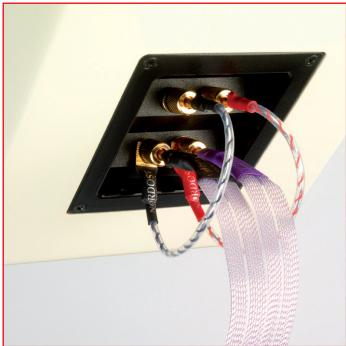
Occasionnellement, bien que rarement, il est possible d'obtenir un rendement supérieur en inversant la configuration, c'est-à-dire en branchant les câbles pour enceintes aux bornes supérieures (aigus). Il vaut tout de même la peine d'essayer, surtout si vous disposez de « tweeters » peu communs ou difficiles à alimenter.
