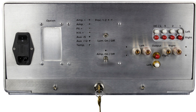
Vue arrière. Un verrou sécurise l'accès au système de rail et l'intérieur du coffret.
