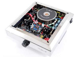
Selon Audio Hungary, aucune dépense n'a été épargnée dans la sélection, la conception ou la construction des pièces de l'A50i. Les transformateurs de sortie sont de type torique et fabriqué en interne et réglé à la fois sur des charges nominales de 4 ohms et de 8 ohms.
