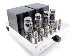
inférieure. Un couvercle inférieur amovible assorti du même matériau offre un accès caché à ses entrailles. Le compliment de tube est disposé dans un modèle symétrique directement devant les transformateurs toroïdaux massifs. Le résultat est une unité de 14 pouces de large, 16 pouces de profondeur et 8,25 pouces de haut sans aucune vis apparente.
