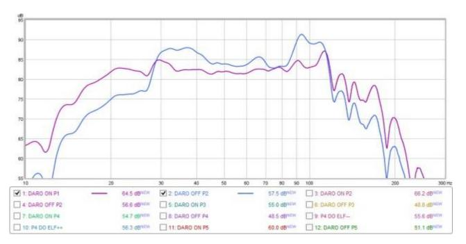
Un test assez facile celui-ci. La réponse pré-EQ n'a pas de creux majeurs. DARO l'a corrigé en une ligne très plate. Il a également appliqué un boost assez substantiel sous 30 Hz.
