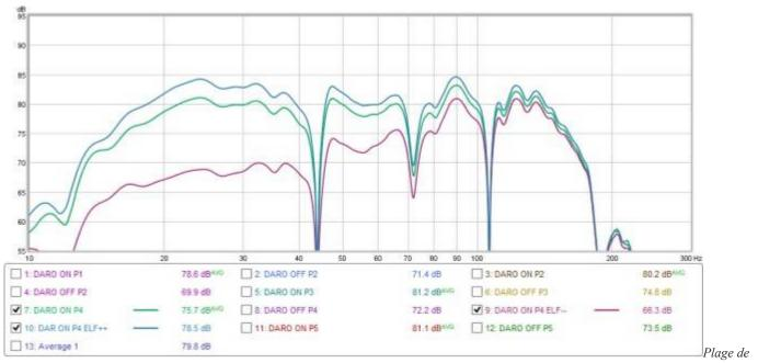
réglage ELF TRIM. La ligne de base est la trace DARO ON P4, — le contrôle ELF est tourné à -12 dB, ++ est le contrôle ELF tourné à +3dB.
