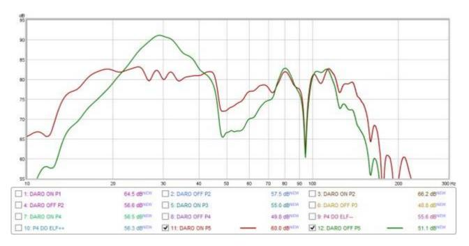
Pour le test cinq, nous avons eu une réponse pré-EQ avec un pic majeur à 30 Hz et un creux significatif à 50-60 Hz, suivi d'un creux d'annulation de phase à 95 Hz. DARO a aplati le pic de manière très efficace et a également augmenté le large creux d'environ 6 dB. Il n'a pas essayé de corriger le pendage étroit et prononcé. Encore une fois, nous voyons le boost appliqué par DARO aux fréquences les plus basses.
