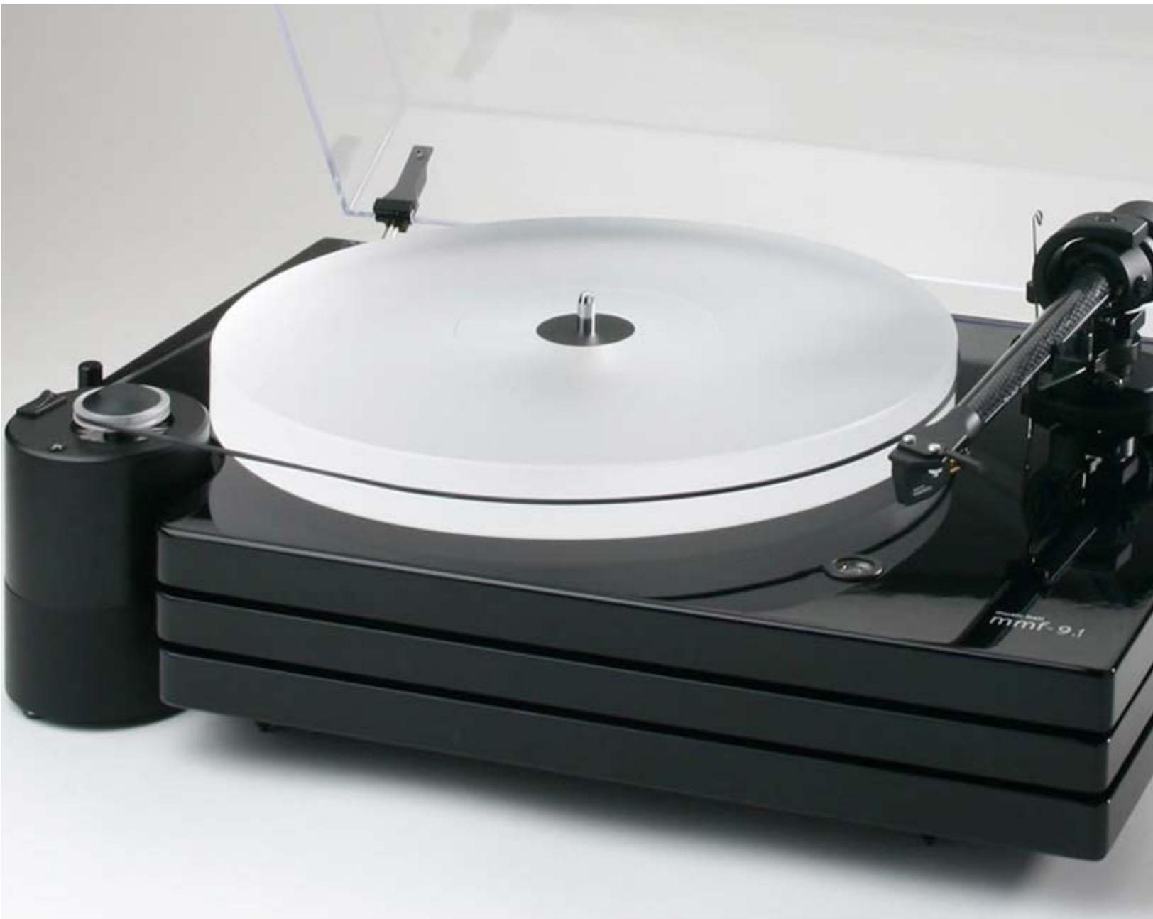
DES HÉMISPÈRES EN SORBOTHANE SÉPARENT CHACUNE DES TROIS SOCLES ET GÈNÈRENT UN AMORTISSEMENT SUPPLÉMENTAIRE DES VIBRATIONS. LE MOTEUR ET LE COMMUTATEUR SONT ISOLÉS SUR LEUR PROPRE BASE AMORTISSANT LES VIBRATIONS ET ENTIÈREMENT DÉCOUPLÉS DE LA PLATINE. LA MMF-9.1 VIENT DANS UNE FINITION PIANO LAQUÉE NOIR HAUTE BRILLANCE ET EST DISPONIBLE AVEC OU SANS CARTOUCHE.
