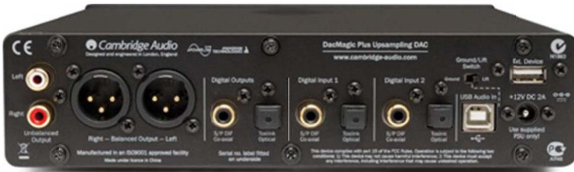
Les autres fonctionnalités clés incluent deux convertisseurs Wolfson WM8740 mise en œuvre en mode différentiel double, un nouveau processeur 32 bits Analog Devices signal numérique, deux entrées numériques coaxiale et avec les deux connexions optiques et XLR symétriques ainsi que les sorties RCA standard phono.
