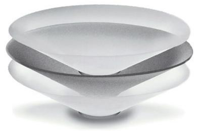
La membrane sandwich composite "W" permet une optimisation parfaite de la courbe de réponse en fréquence, dès la conception du cône, grâce à la maîtrise totale des trois paramètres clés : légèreté, rigidité et amortissement. Le sigle "W" signifie Verre/Verre, car il s'agit de deux feuilles de verre, ou plus, qui sont apposées de part et d'autre du corps central en mousse structurale. La rigidité est apportée par la structure sandwich des tissus de fibres de verre.
