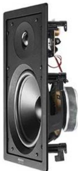
***C'est une enceinte 2 voies dotée d'un haut-parleur médium-grave de 16,5 cm (6,5 pouces) en fibres de cellulose et d'un tweeter à dôme de soie de 19 mm. Celui-ci peut être orienté afin d'optimiser l'émission du son vers la zone d'écoute en fonction de son emplacement. La grille aimantée fournie est blanche, elle peut être facilement peinte pour une intégration parfaite.***
