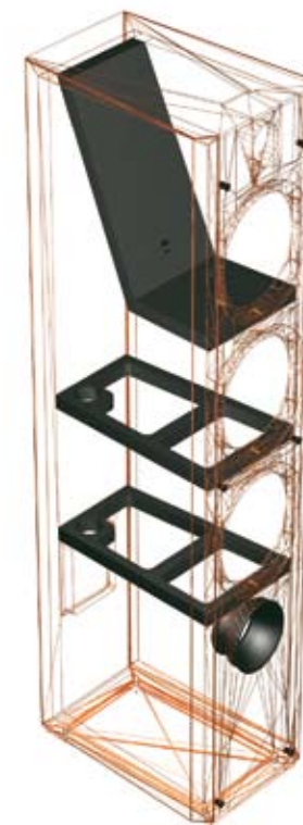
> Le souci permanent du détail est une démarche typiquement haut de gamme : construction en MDF jusqu'à 25 mm d'épaisseur, renforts internes multiples intégrant le passage des câbles, structure non parallèle des parois, chaque détail est parfaitement intégré à la conception. Des prestations uniques dans cette gamme de prix.
